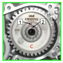
2- POSITION THE GEAR ON THE BALANCER SHAFT SO THAT YOU CAN READ THE LETTER "C" ON THE SURFACE AND ALIGN THE MARKED SEAT ON GEAR (1) WITH THE MARKED TOOTH ON THE BALANCER SHAFT (2).
