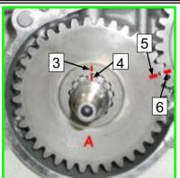
3- POSITION THE GEAR ON THE CRANKSHAFT SO THAT YOU CAN READ LETTER "A" ON THE SURFACE AND ALIGN THE MARKED SEAT ON THE GEAR (3) WITH THE MARKED TOOTH ON THE CRANKSHAFT (4). MAKE SURE THE GEARS TEETH ARE IN CORRECT POSITION BY CHECKING THAT THE TWO REFERENCE
